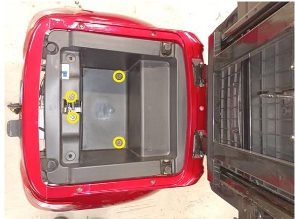
Käännä laitteen päävirtakytkin off- asentoon ja irrota kuvassa näkyvät kiinnityspultit. (kuusiokoloavain 8 mm).
